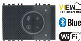
03975 Встроенная Alexa со встроенным Wi-Fi, 2 фронтальные клавиши, светодиодная RGB-подсветка, 1 вход для проводной кнопки, 1 НО релейный выход 100-240 В 50/60 Гц для ламп накаливания 500 Вт, светодиодные лампы 100 Вт, электронные трансформаторы 250 ВА, люминесцентные лампы 120 Вт, управляемые локально или дистанционно, беспроводная технология Bluetooth ® 5.0 для Mesh-системы View Wireless или Vu-me Plus, блок питания 100-240 В 50/60 Гц - 3 модуля. Глубина: 35 мм
